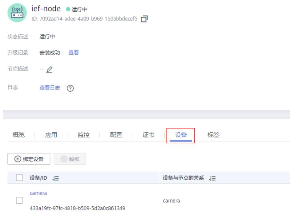
5. 绑定设备之后，单击终端设备名称，进入终端设备详情页面，可以修改终端设备的属性信息，查看终端设备关联的节点、设备孪生信息、标签等。
